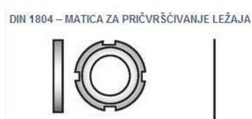
Slika 37. Matica za pričvršćivanje ležaja
