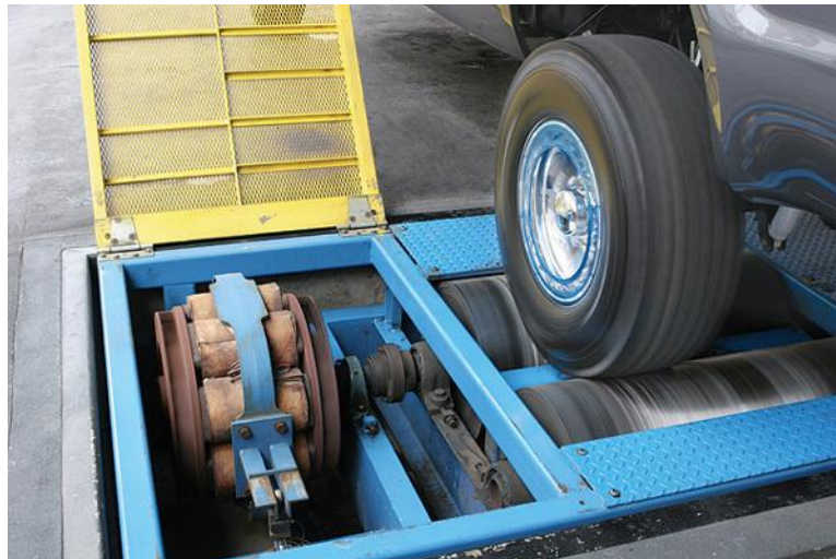
Slika 3. Valjci za mjerenje snage
