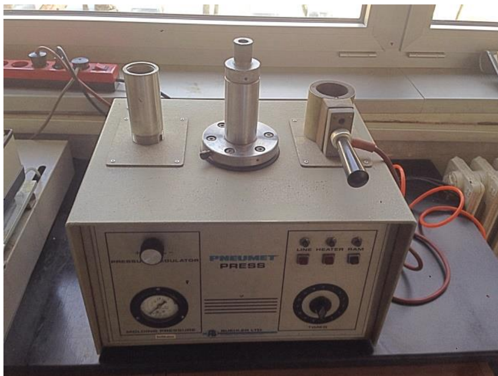
Slika 17 Uređaj za učvršćivanje uzorka (zalijevanje) u polimernoj masi (topli postupak)
