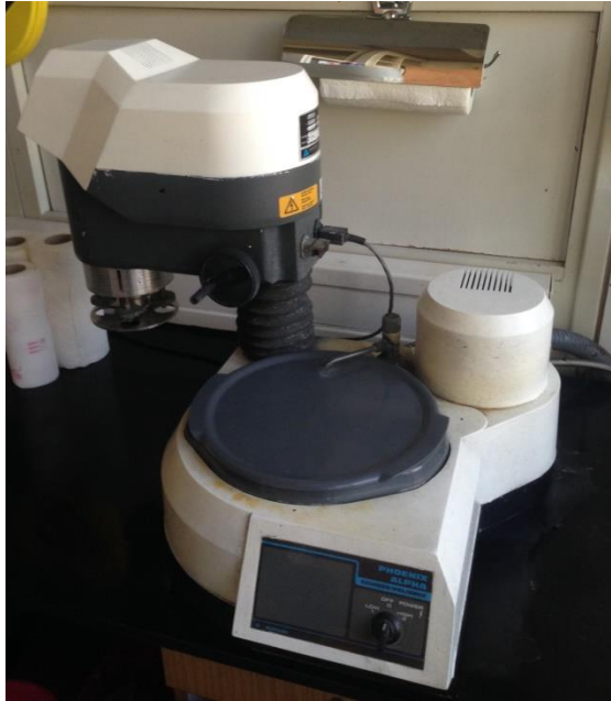
Slika 28 Uređaj za strojno brušenje metalografskih uzoraka
