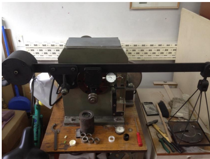
Slika 38 Uređaj za ispitivanje adhezije „Block on ring“ metodom
