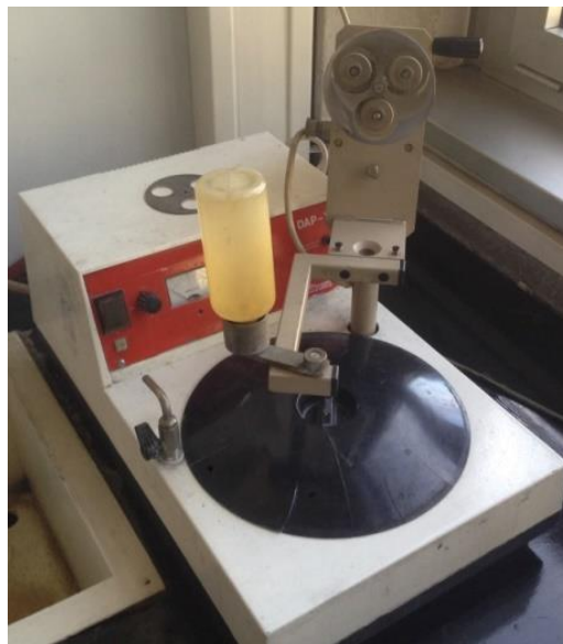
Slika 29 Uređaj za pripremu metalografskih uzoraka poliranjem
