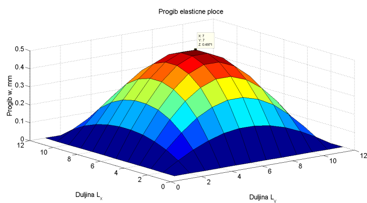
Slika 3.9: Progib: w = 0,4971 mm ( 8 \times 8 )
