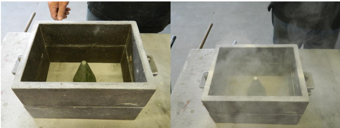
Slika 6.14. Postavljanje modela u kalupnik (lijevo) te posipanje likapodijem (desno)
