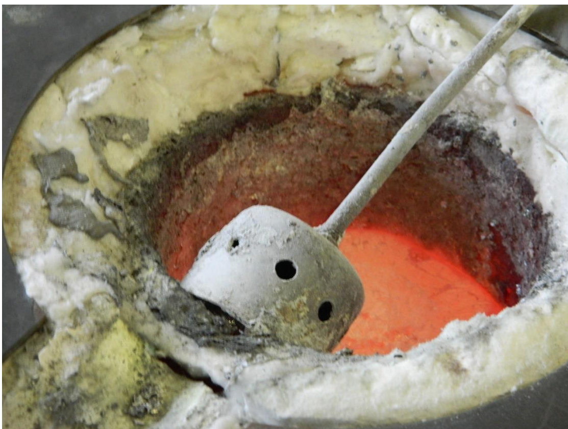
Slika 6.28. Grijanje modifikatora u zvonu za uranjanje
