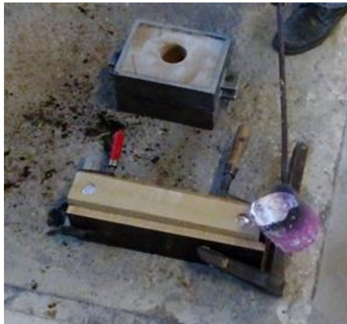
Slika 6.23. Lijevanje epruvete u kalup izrađen postupkom vodeno staklo-CO 2
