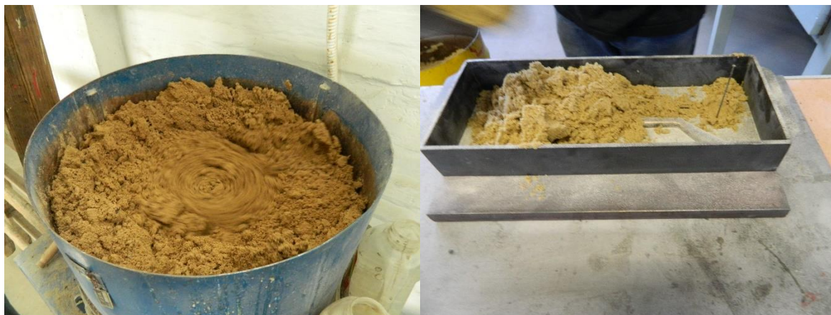
Slika 6.9. Miješanje kalupne smjese (lijevo) te njeno usipanje u kalupnik (desno)
