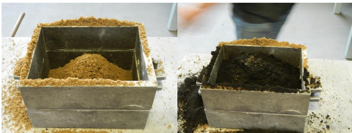
Slika 6.15. Zasipavanje modela modelnom kalupnom mješavinom (lijevo), popunjavanje kalupa dopunskom kalupnom mješavinom (desno)
