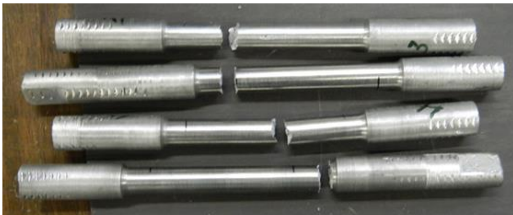
Slika 6.44. Epruvete nakon kidanja
