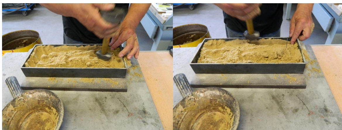
Slika 6.10. Sabijanje kalupne mješavine
