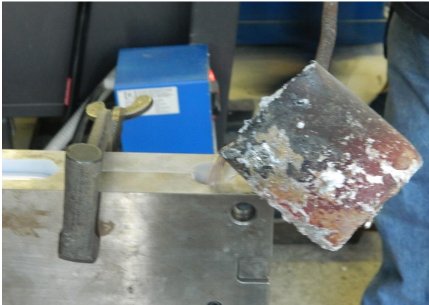
Slika 6.22. Ulijevanje taljevine u kokilu
