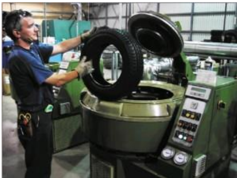
Slika 3.9. Kalup i stroj za vulkanizaciju za završnu fazu proizvodnje pneumatika [65]
