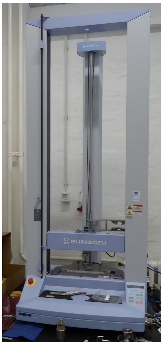
Slika 6.12. Shimadzu AGS-X za ispitivanje savojnih svojstava
