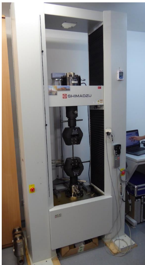
Slika 6.8. Kidalica Shimadzu AG-IC 300 kN za ispitivanje rasteznih svojstava
