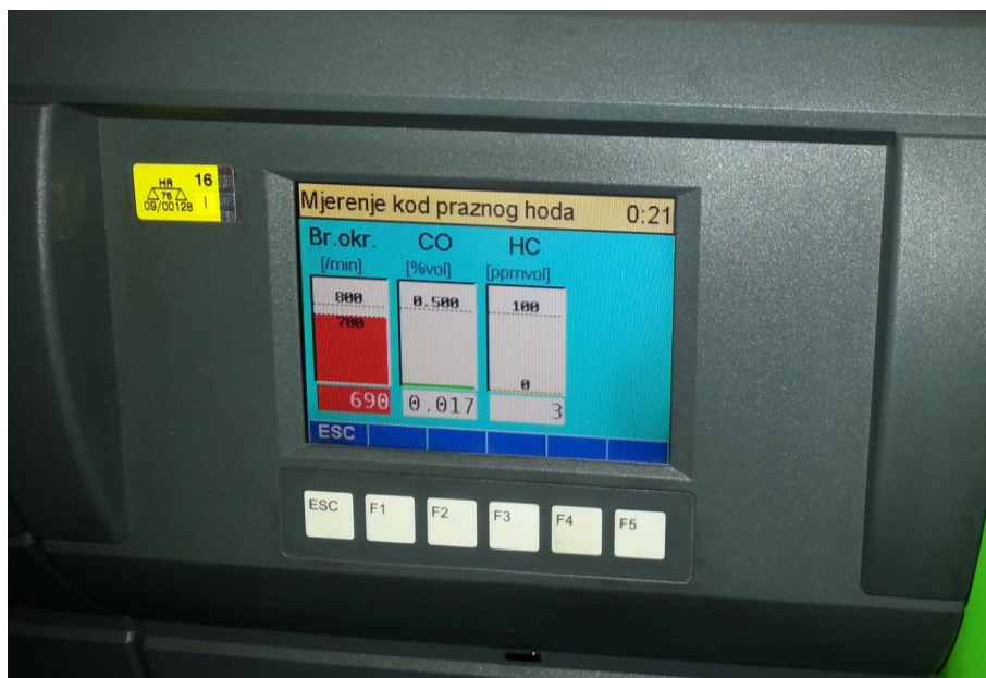
Slika 31. Mjerenje emisija pri povišenom hodu
