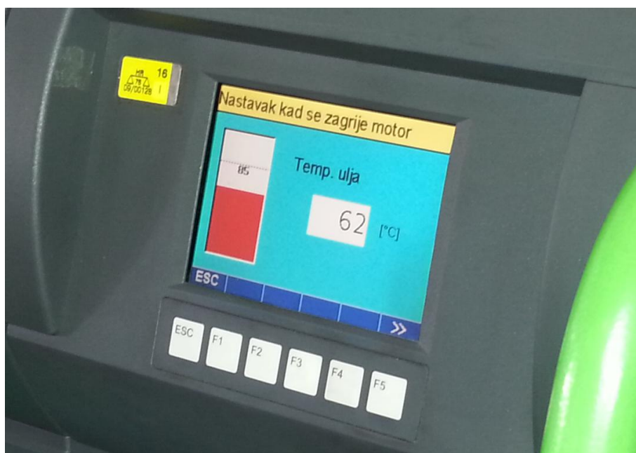
Slika 29. Zagrijavanje motora, odnosno katalizatora na radnu temperaturu
