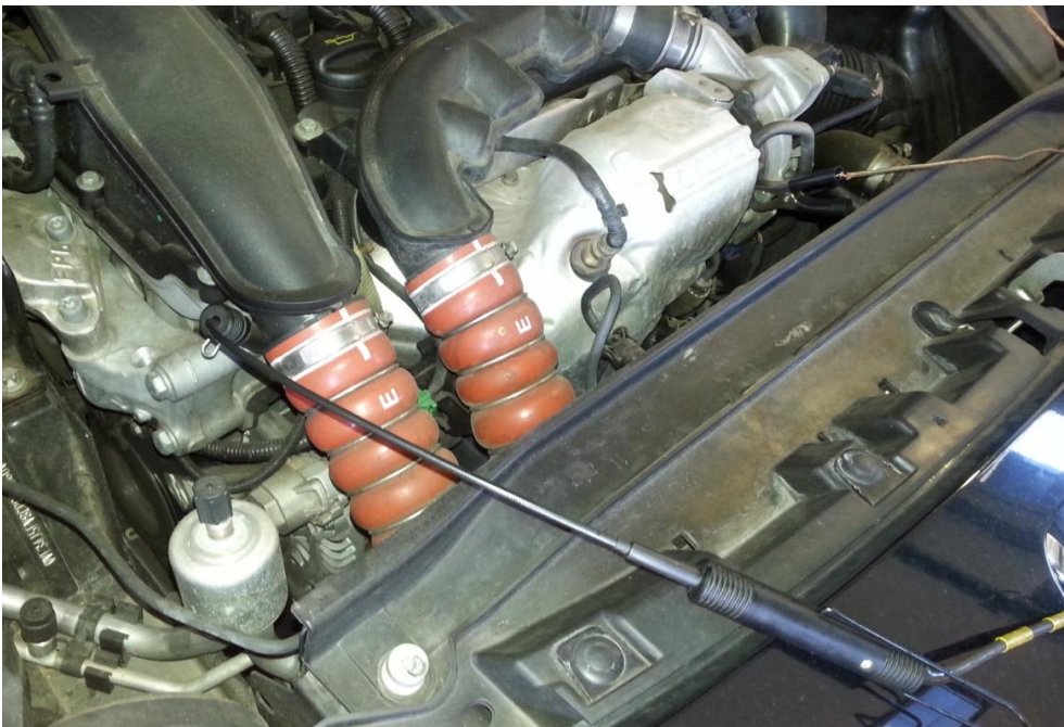
Slika 27. Umetanje osjetnika temperature u karter ulja
