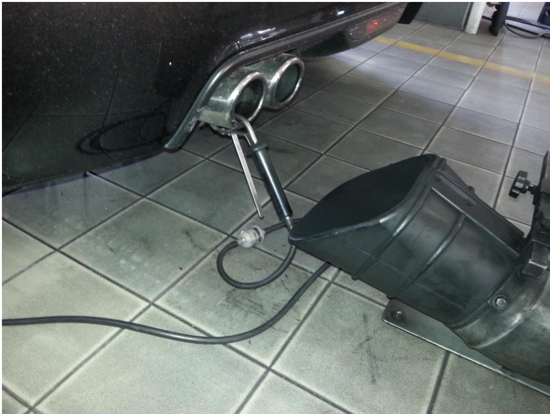
Slika 28. Umetanje sonde za uzimanje uzoraka u ispušnu cijev vozila
