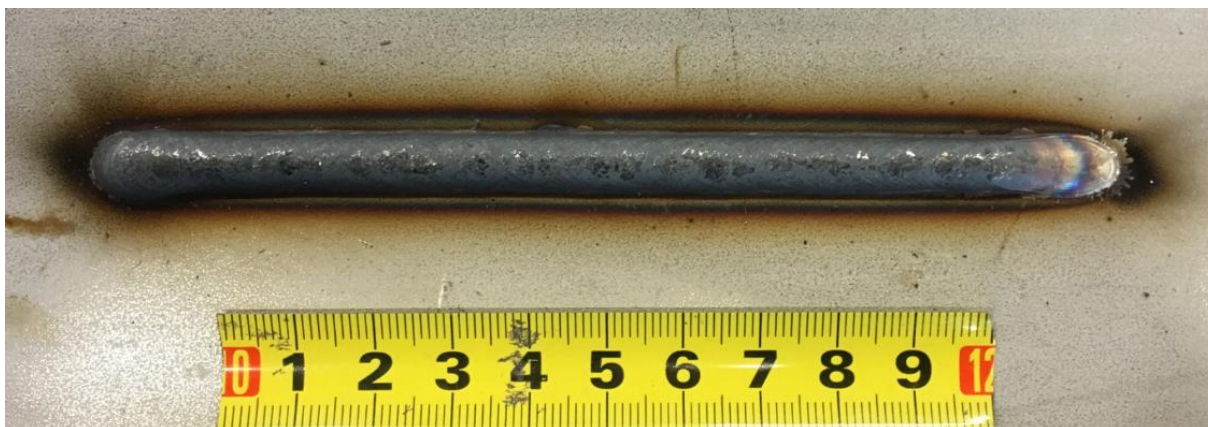
Slika 22 Rezultat navarivanja uzorka 1A
