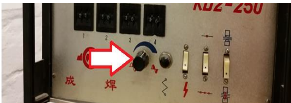
Slika 31. Regulacija jakosti struje zavarivanja
