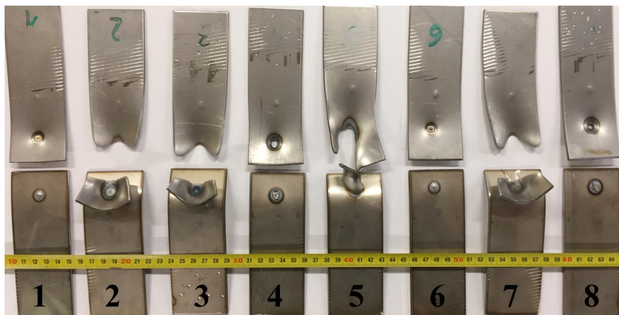
Slika 47. Uzorci nakon ispitivanja na kidalici
