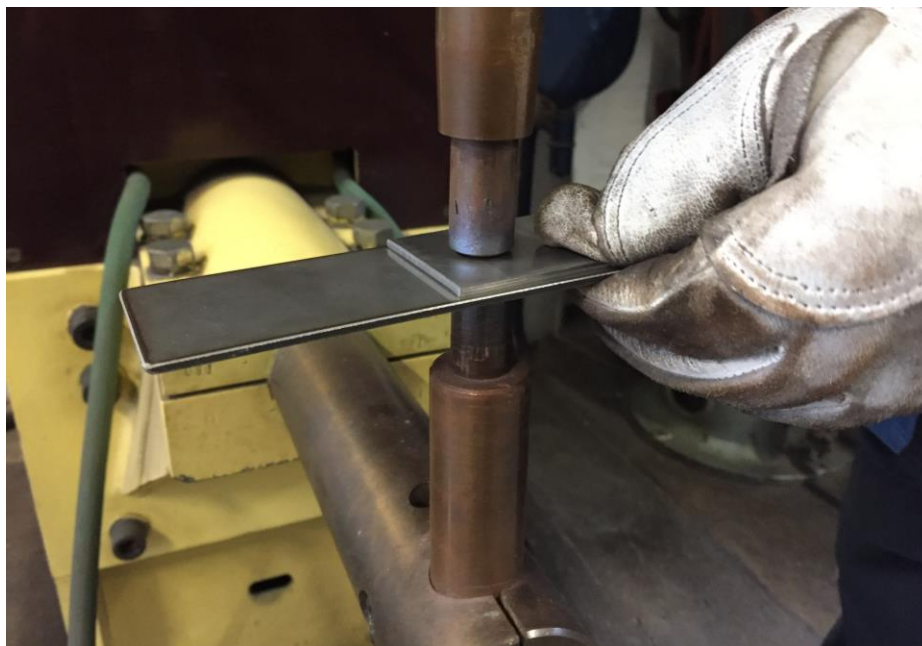
Slika 38. Pozicioniranje uzorka prije zavarivanja na stroju DZ-63
