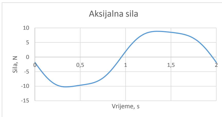
Slika 90. Aksijalna sila na uniball-u pushrod-a
