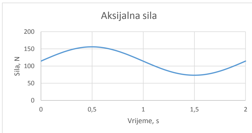
Slika 85. Aksijalna sila na uniball -u spone volana
