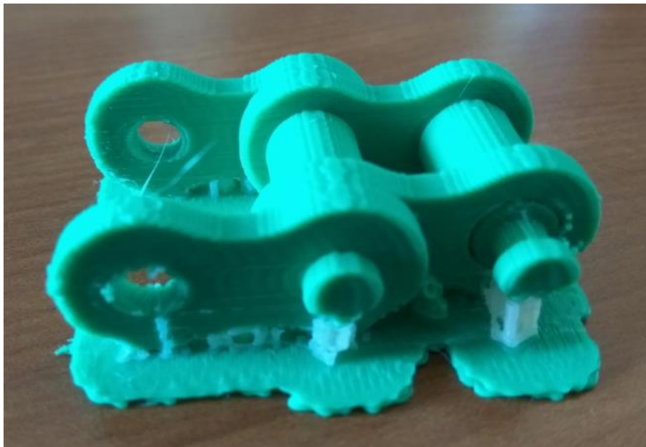
Slika 4.23. Proizvod A nakon izlaska iz 3D pisača
