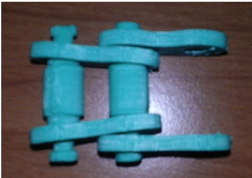
Slika 4.9. Proizvod A izrađen s razmakom između dijelova od 0,6 mm
