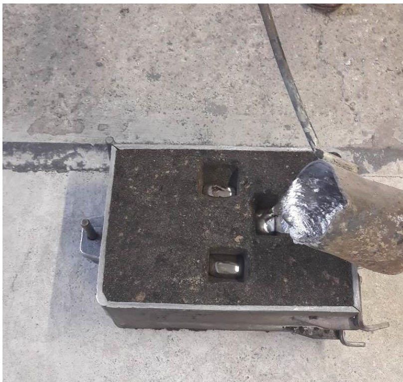
Slika 47. Ulijevanje legure kroz pojilo na gornjoj prirubnici.
