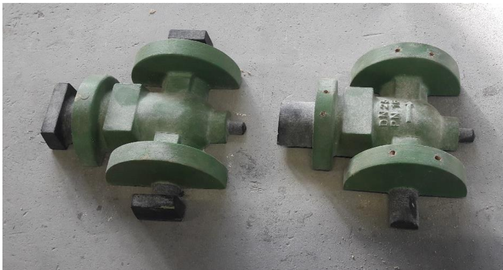
Slika 25. Dvodjelni model odljevka.
