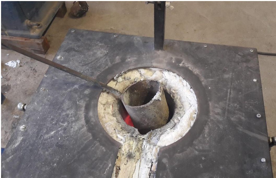
Slika 44. Zagrijavanje lonca za lijevanje
