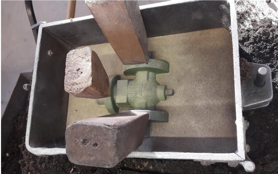
Slika 31. Poziciniranje modela pojila u gornjak.
