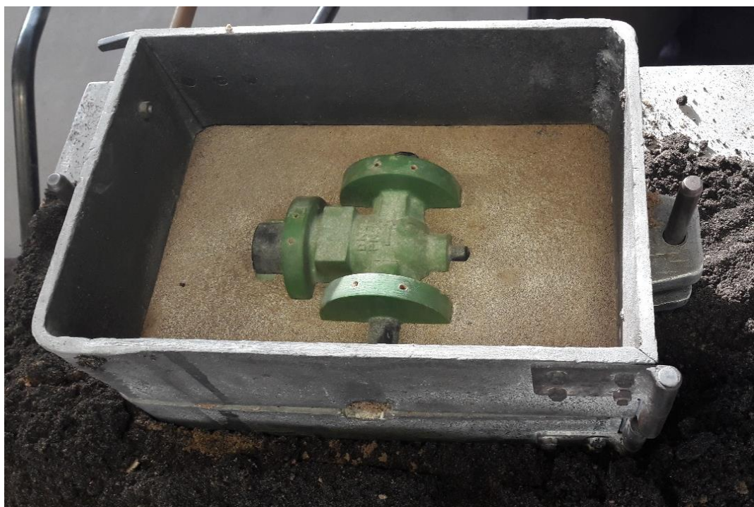
Slika 30. Gornji dio modela posipan likapodijem.
