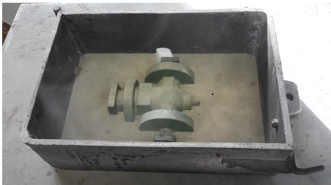
Slika 26. Donji dio modela posipan likapodijem.
