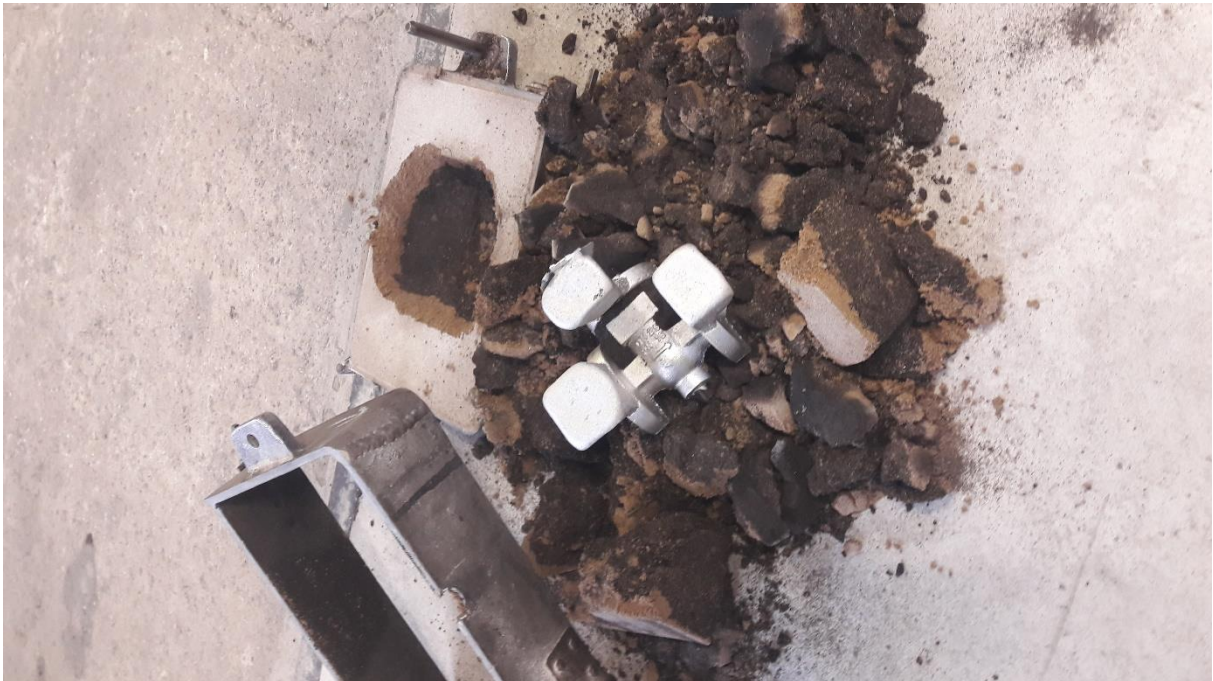
Slika 50. Odvajanje odljevka od kalupne mješavine.
