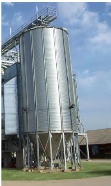
Slika 18. Silos s lijevkom
