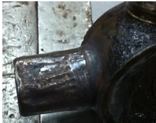
Slika 20. Oštećenje uslijed nedostatka maziva [17]
