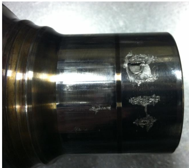
Slika 22. Oštećenje zbog prevelikog operativnog kuta među vratilima [17]
