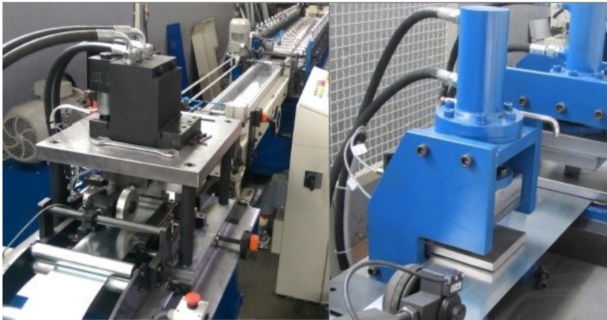
**Slika. 25. Hidraulična preša za štancanje [13.]**
