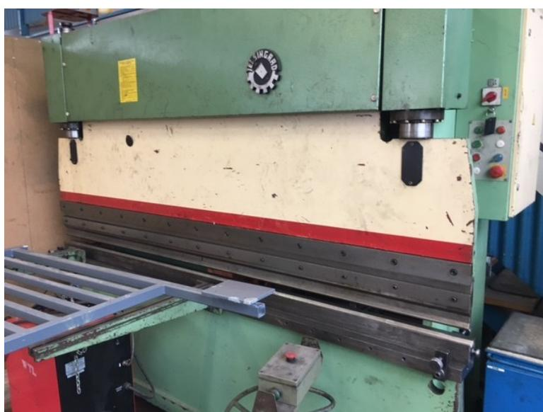
**Slika. 9. Hidraulična savijačica HAPA 80 [5.]**
