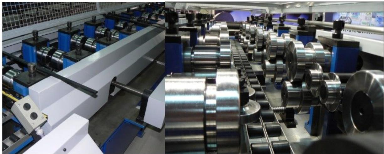
**Slika. 26. Stroj za profiliranje [13.]**
