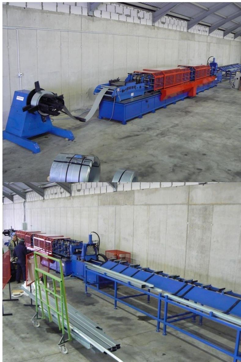
Slika. 21. Automatska linija za proizvodnju perforiranih kabelskih kanala [13.]
