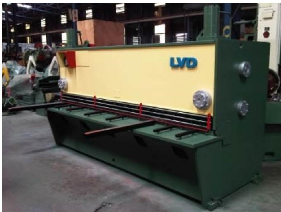
Slika. 18. Hidraulične škare MG 20/2 [12.]
