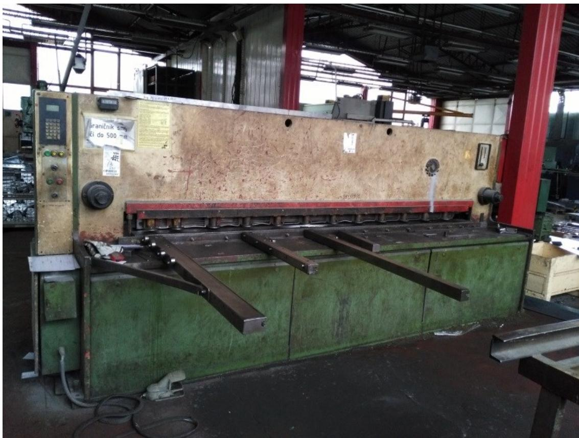
Slika. 7. Hidraulične škare MG 31/6 [5.]
