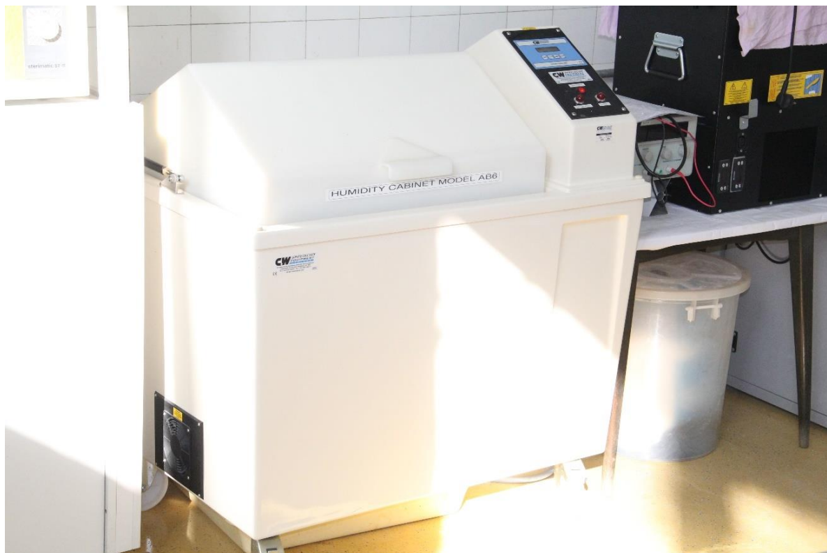
Slika 43. Ispitivanje uzoraka u slanoj komori Humidity cabinet model AB6
