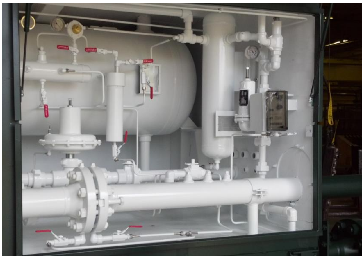
Slika 12. Hibridni epoksi premaz u naftnoj industriji [32]
