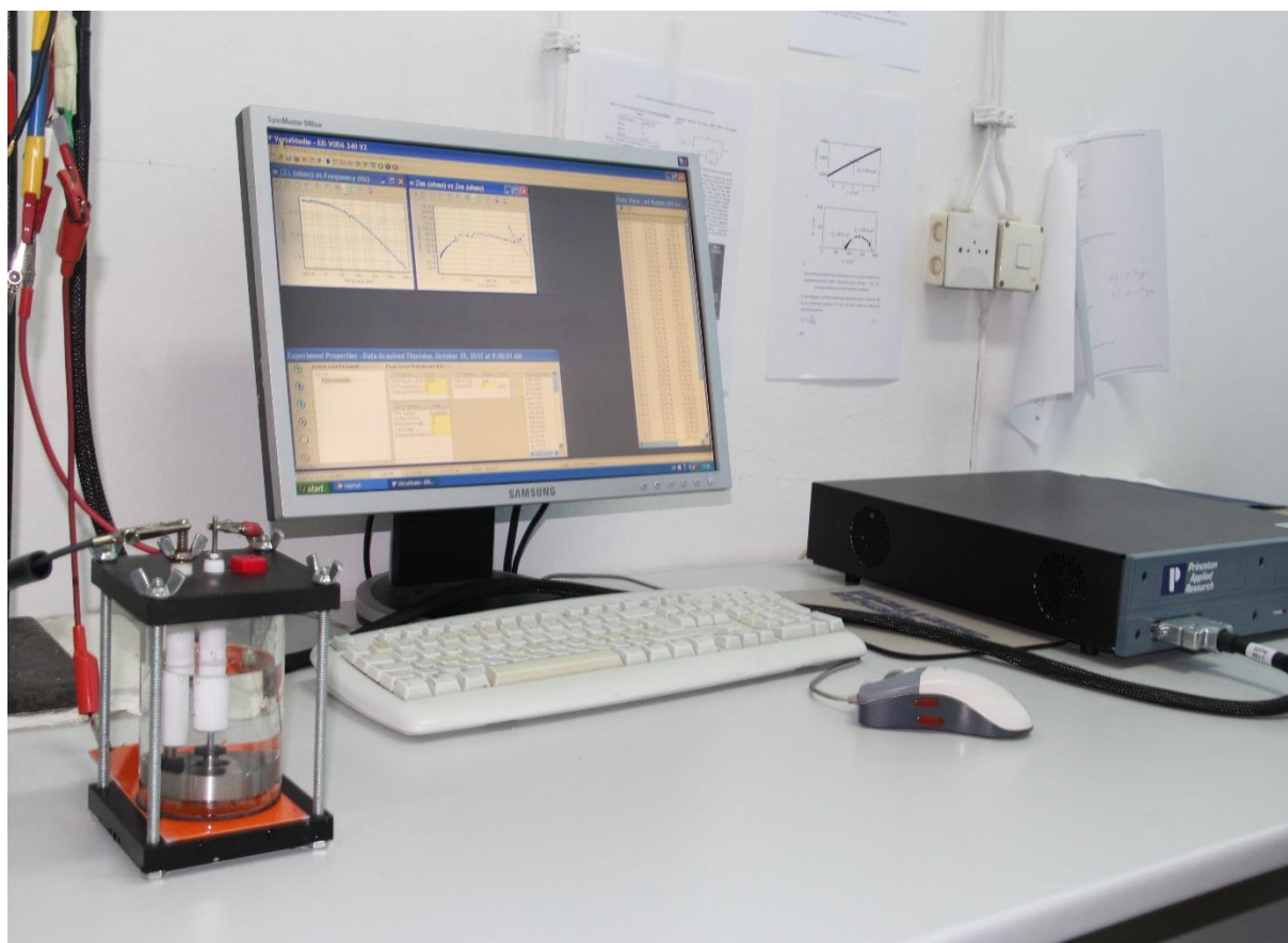
Slika 48. Oprema za EIS ispitivanje
