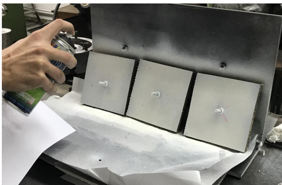
Slika 60. Nanošenje uzorka crnih točkica na ispitne uzorke
