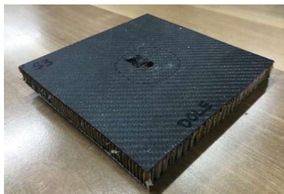
Slika 75. Uzorak S3 nakon testiranja: a) gornja strana uzorka i b) donja strana uzorka
