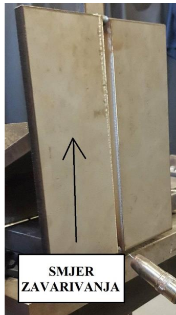
Slika 38. Položaj i smjer zavarivanja
