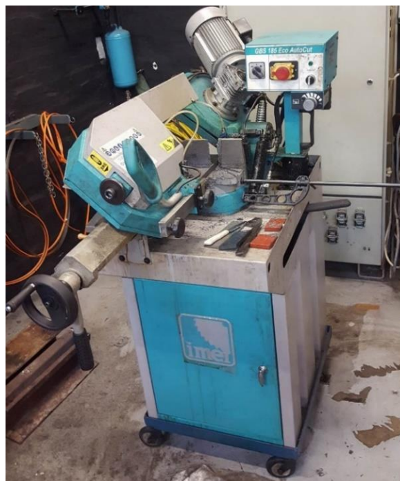
Slika 55. Rezanje uzoraka na tračnoj pili
