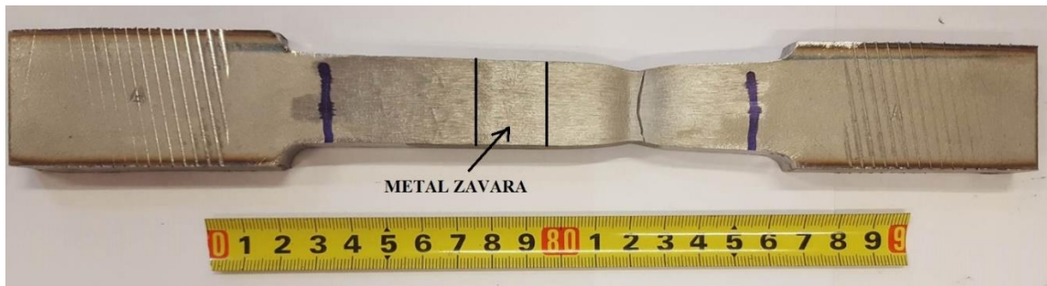
Slika 84. Uzorak A nakon statičkog vlačnog ispitivanja
