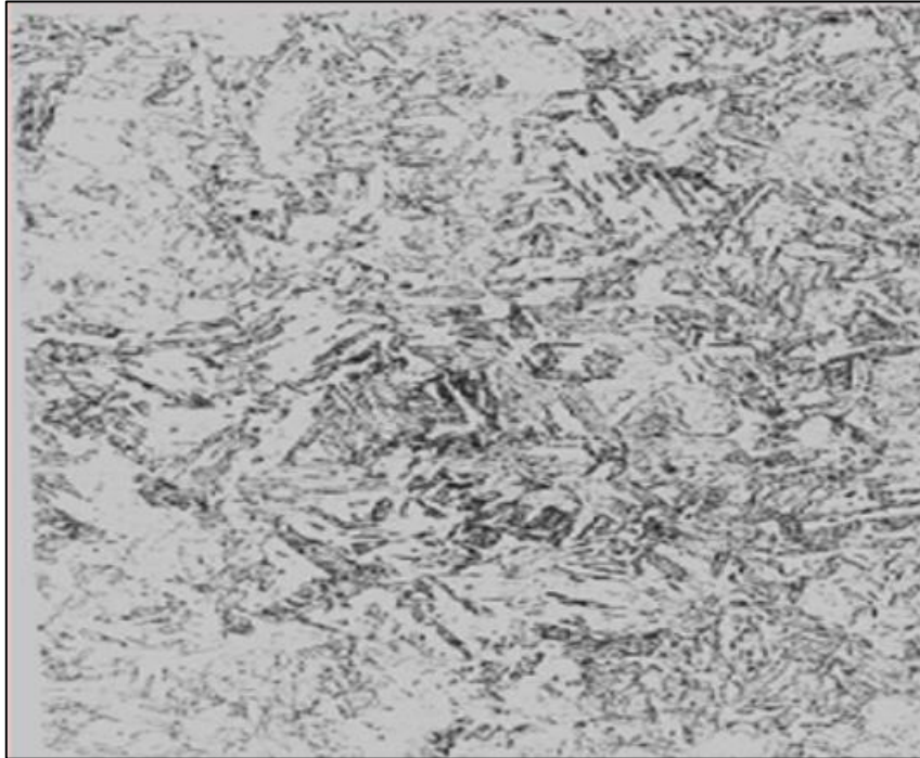
Slika 4. Mikrostruktura martenzitnog nehrđajućeg čelika [3]
