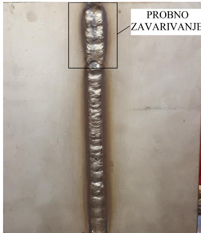
Slika 46. Izgled popune zavara uzorka B
