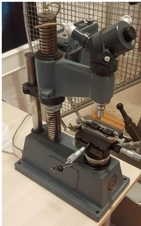
Slika 62. Uređaj za mjerenje tvrdoće
