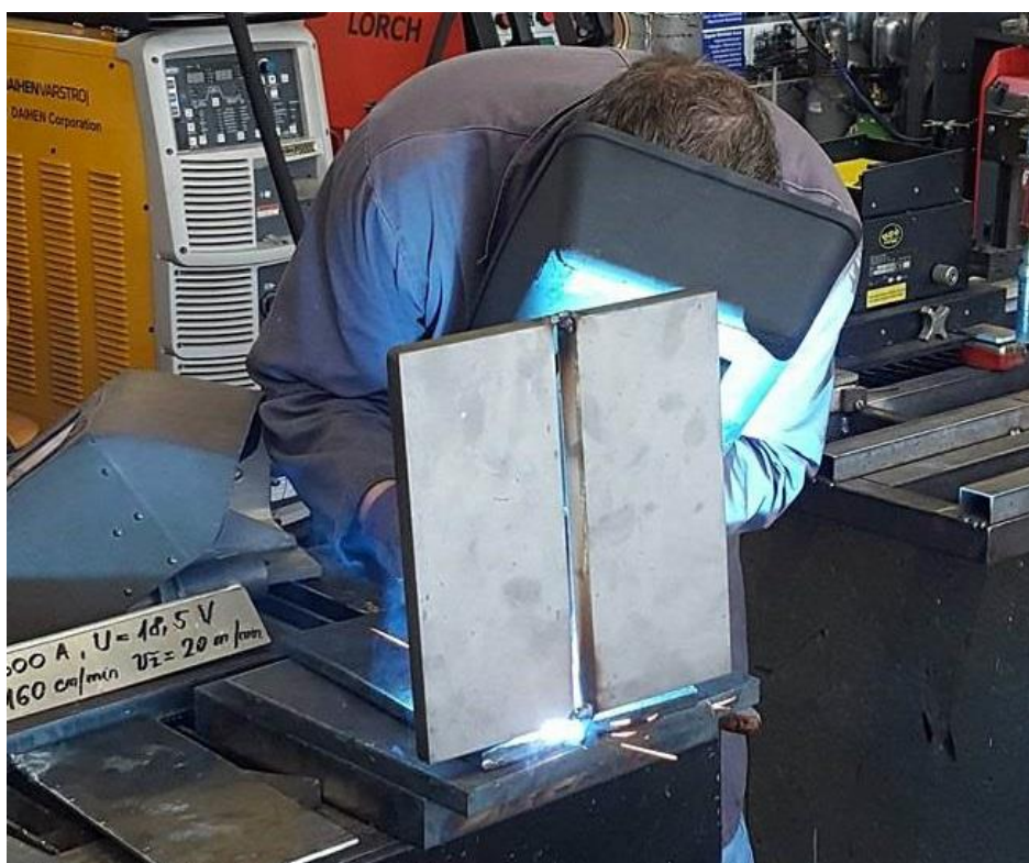
Slika 35. Pozicioniranje u vertikalni položaj i zavarivanje pripoja
