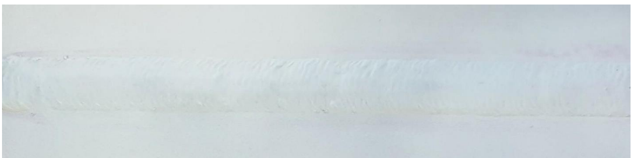
Slika 73. Uzorak A s nanesenim razvijanjem - lice zavara
