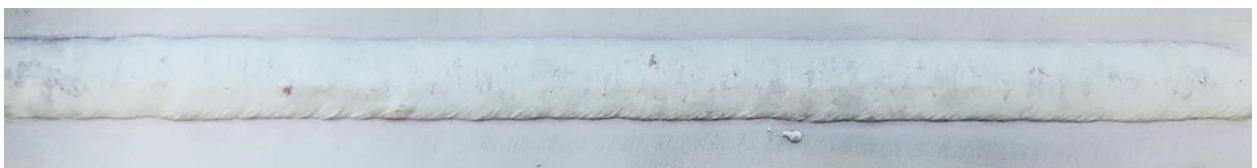
Slika 76. Uzorak B s nanesenim razvijačem - korijen zavora
