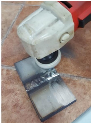
Slika 65. Mehanička obrada površine uzorka
