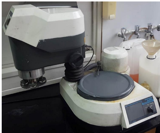
Slika 56. Uređaj za brušenje BUEHLER PHOENIX ALPHA
