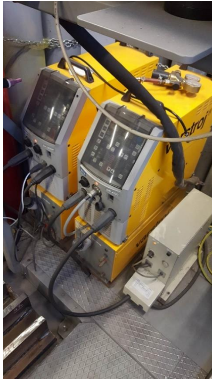
Slika 32. Izvor struje OTC Daihen Varstroj DP400
