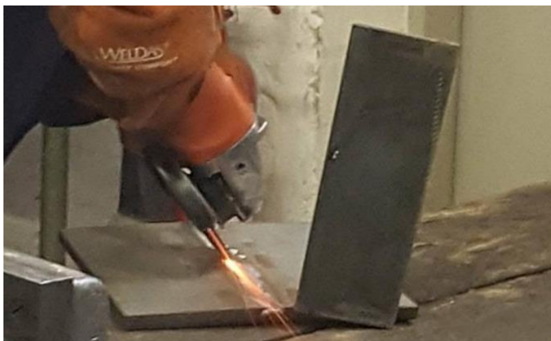
Slika 42. Brušenje korijena zavora - uzorak A
