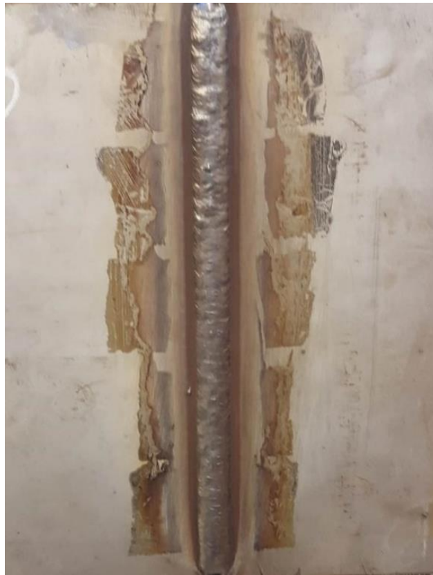
Slika 47. Izgled novog korijena zavora uzorka B
