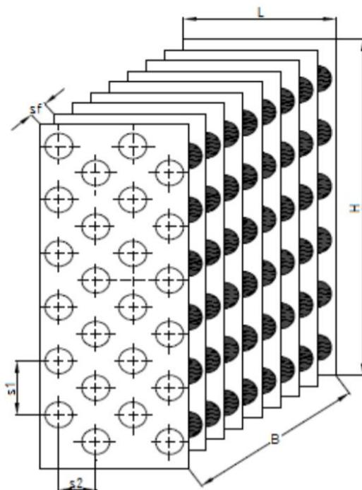
Slika 18 Konstrukcijski parametri isparivača
