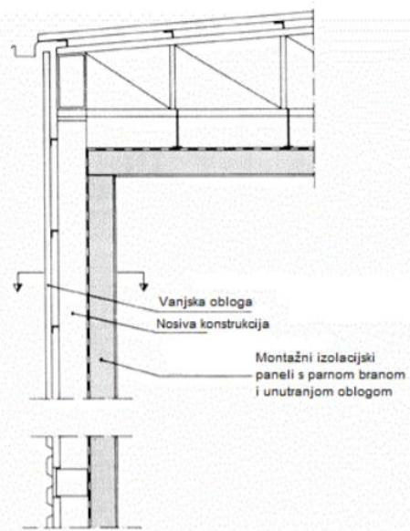
Slika 4 Nosiva konstrukcija s vanjske strane hladionice
