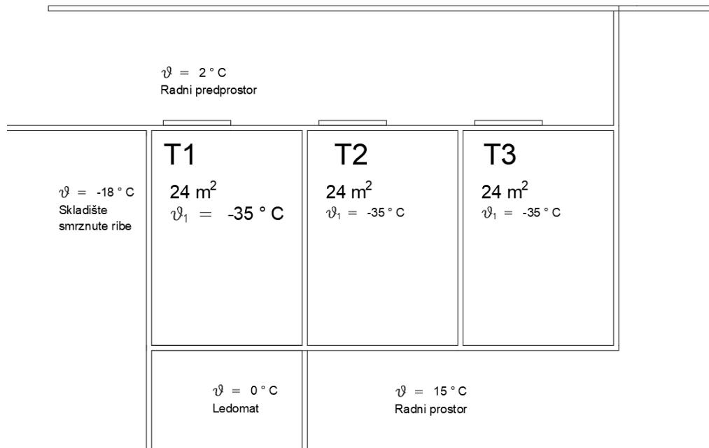
Slika 6 Tlocrt tunela za zamrzavanje
