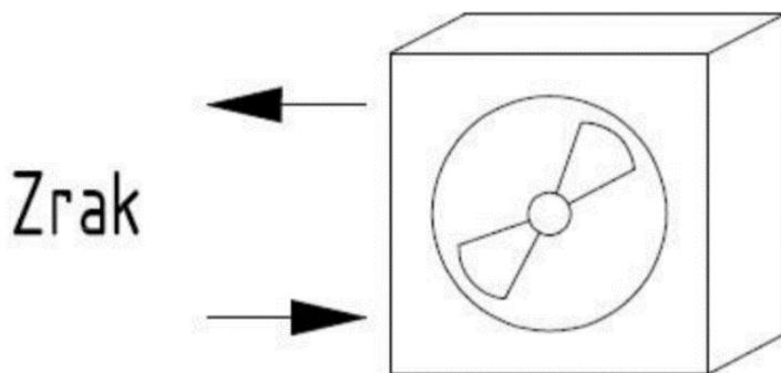
Slika 17 Isparivač radna tvar – zrak
