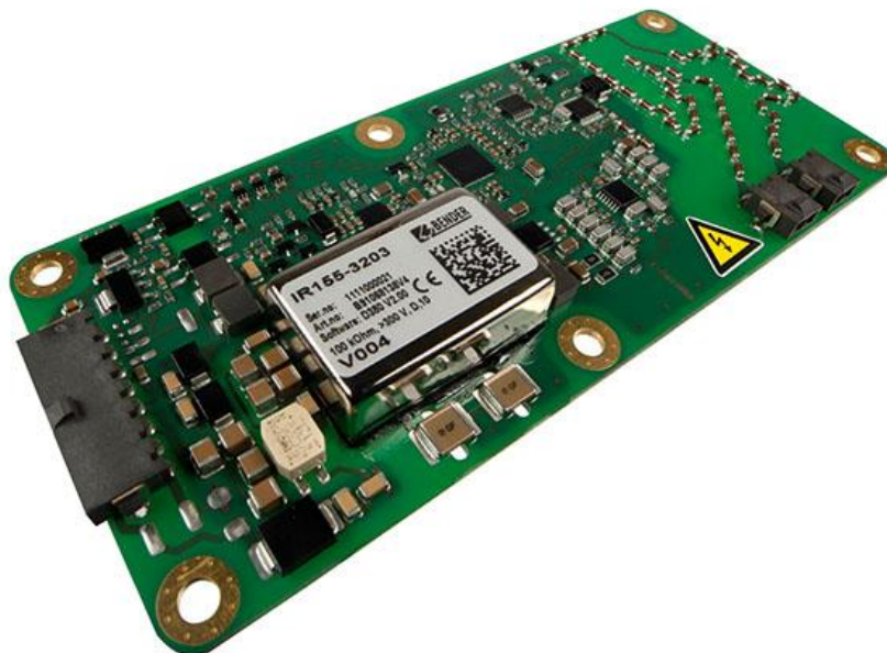
Slika 11. Uređaj za nadzor izolacije [10]
