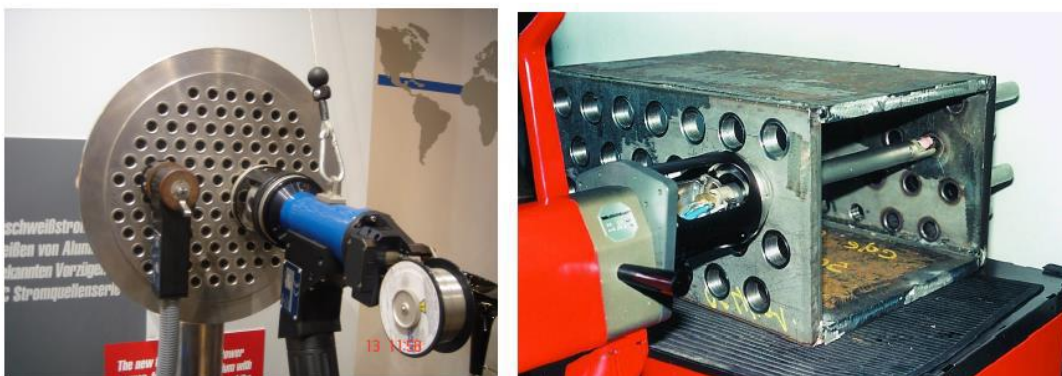
Slika 32. Primjer glave za zavarivanje u cijevnu stjenku [26]
