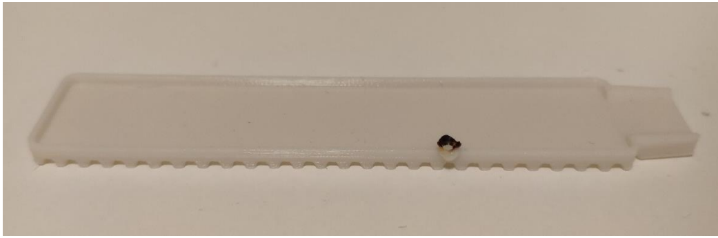
Slika 39. Greška u printeru nastala pregrijavanjem mlaznice
