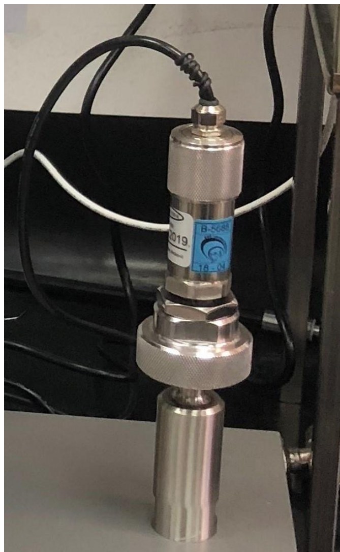
Slika 11. WIKA P-30 električni pretvornik
