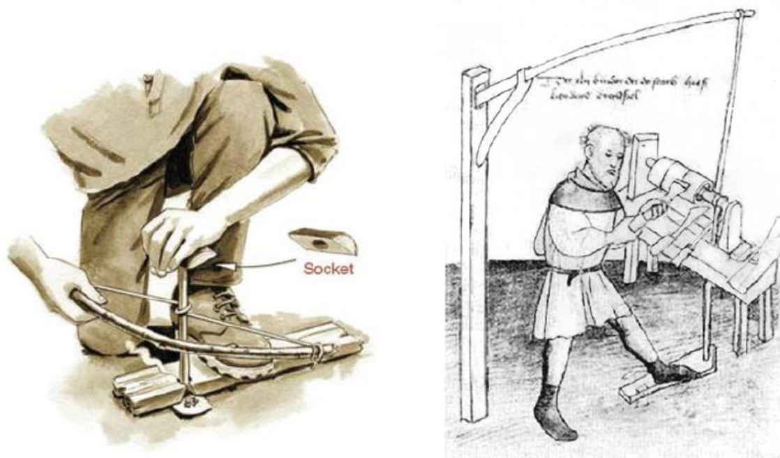
Slika 6. Paljenje vatre (lijevo) i konstrukcija prve tokarilice (desno)
