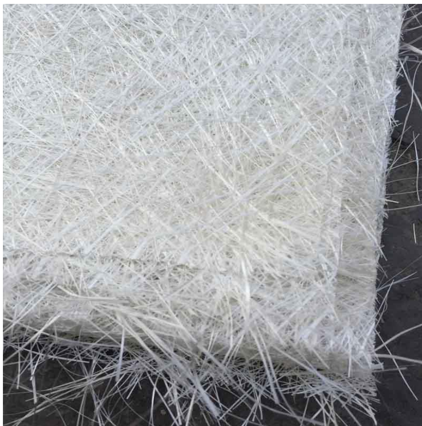
Slika 6. Mat staklena vlakna [7].
