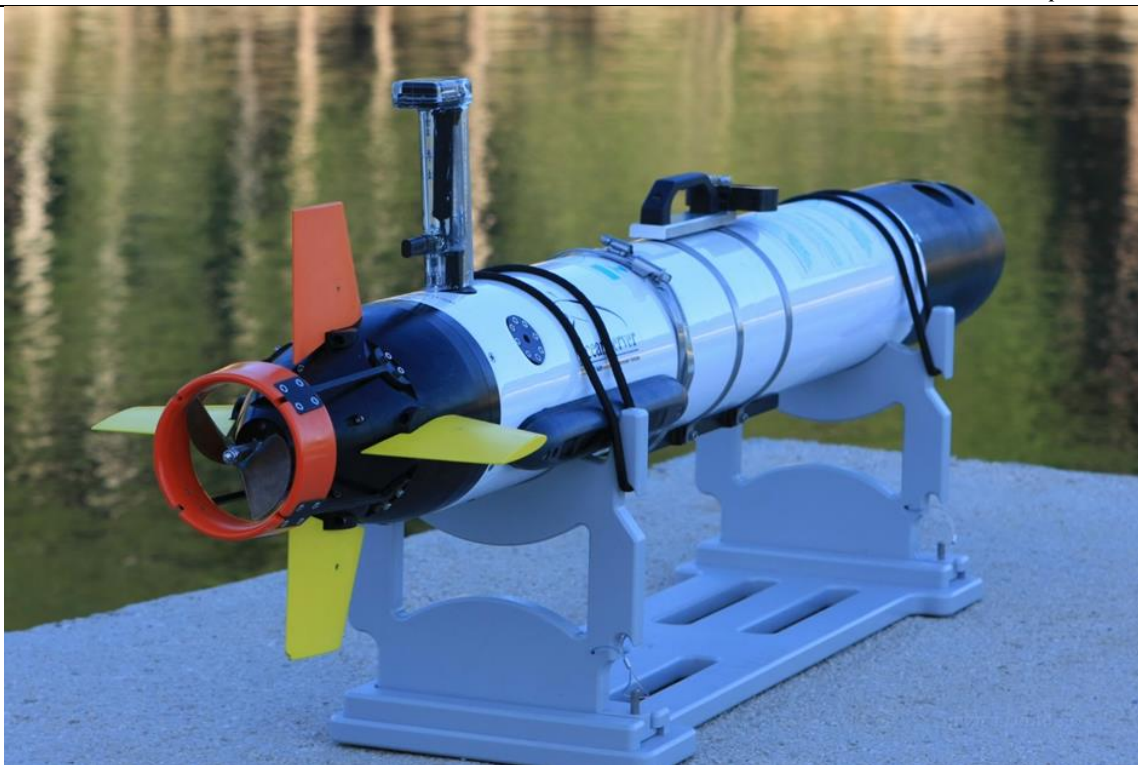
Slika 2.24 OceanServer IVER2 AUV Laboratorija za podvodne sustave i tehnologije
