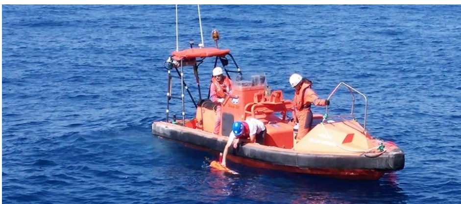
Slika 2.15 Lansiranje ronilice OceanScan LAUV na misiju (20kg)
