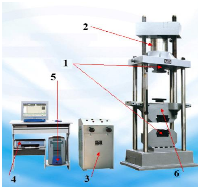
Slika 18. Suvremena hidraulička kidalica [6]
