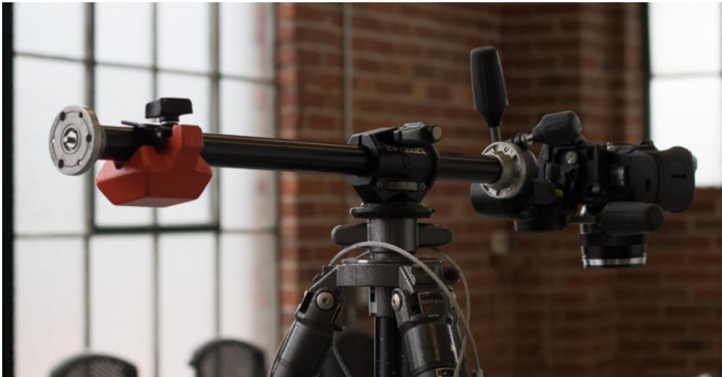
Slika 57. Teleskopska ruka s protutegom [30]
