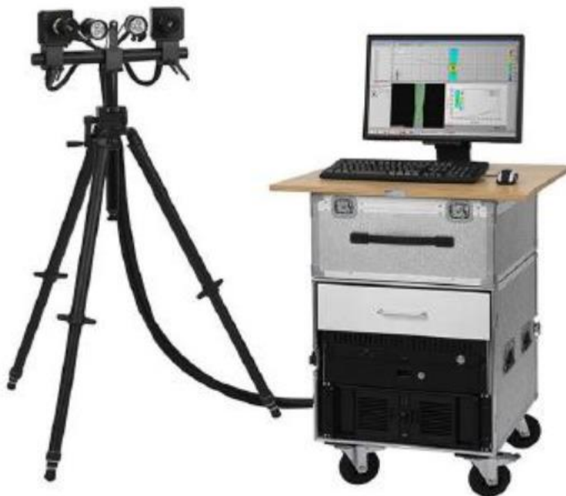
Slika 28. Optički mjerni sustav Aramis [14]
