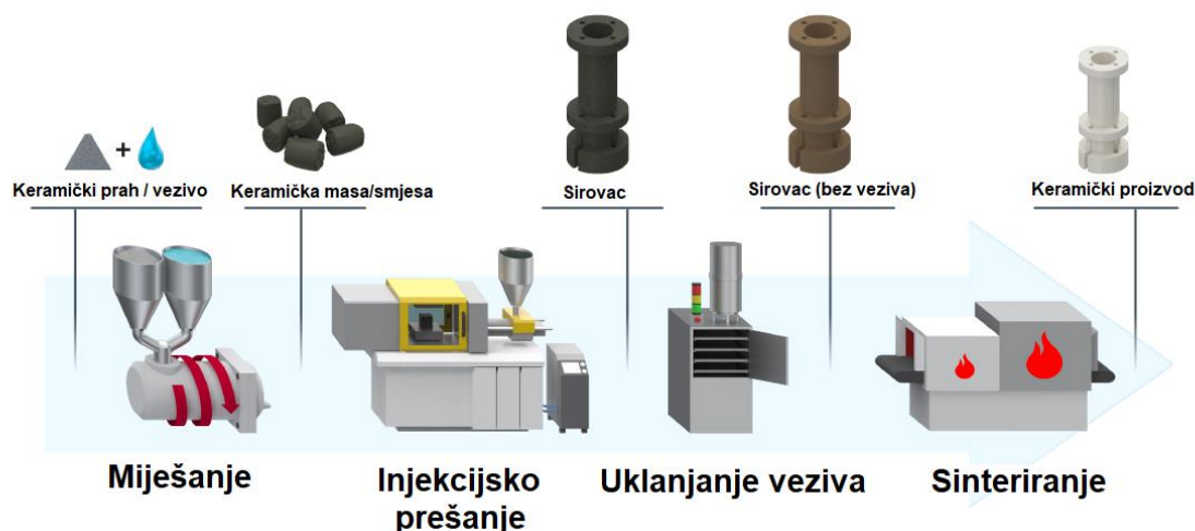
Slika 11. Postupak injekcijskog prešanja keramike (CIM)[17]
