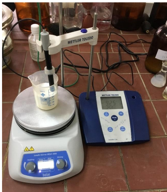
Slika 21. Mjerenje pH vrijednosti suspenzije
