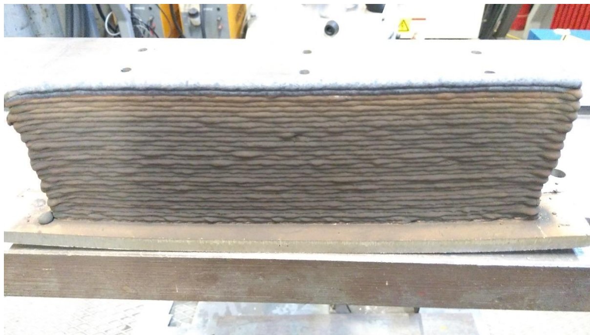
Slika 52. Zid dobiven postupkom zavarivanja coldArc
