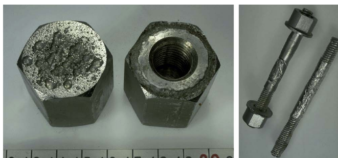
Slika 3. Prikaz korozije u procijepu legure Hastelloy C-4 [19]
