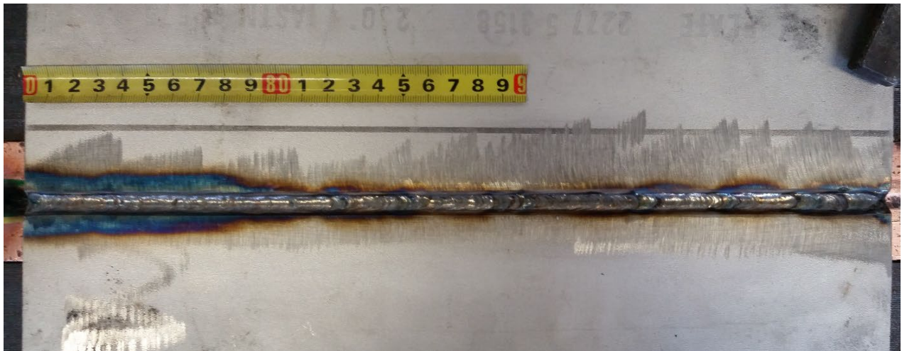
Slika 61. Prikaz korijenskog prolaza s prednje strane zavara nakon zavarivanja, Laboratorij za zavarivanje, FSB, Zagreb
