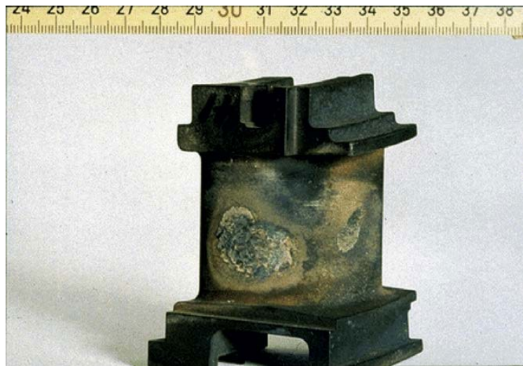
Slika 8. Prikaz nitiranja legure Inconel 738 [19]
