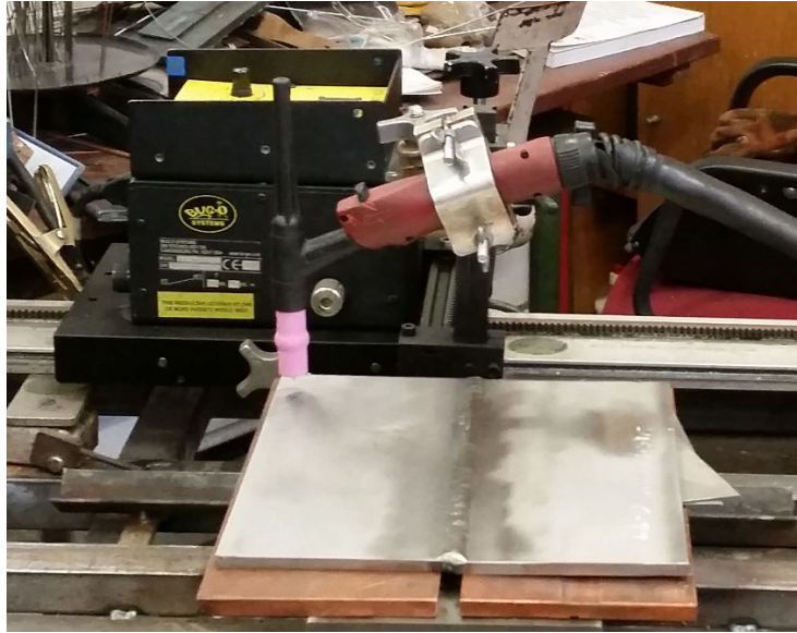
Slika 47. Prikaz naprave za automatiziranje procesa zavarivanja „BUGO Systems“, Laboratorij za zavarivanje, FSB, Zagreb
