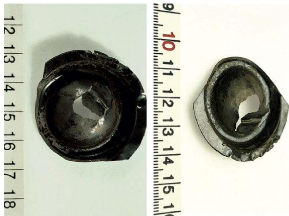
Slika 7. Prikaz napetosne korozije tehnički čistog nikla [19]
