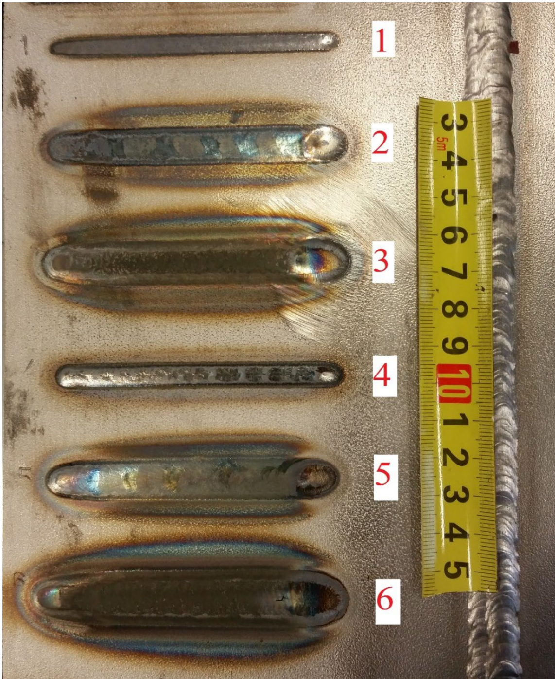
Slika 53. Prikaz svih šest prolaza izvedenih navarivanjem, Laboratorij za zavarivanje, FSB
