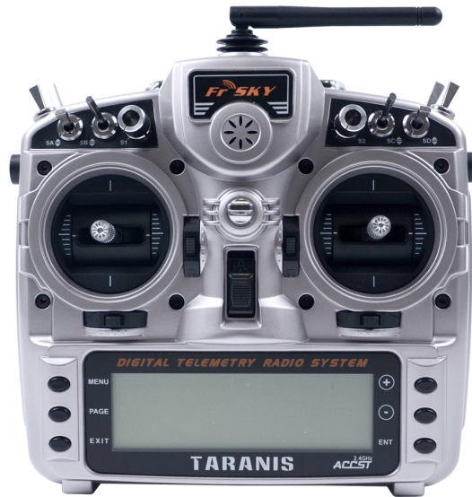
Slika 7.1: Taranis X9D Plus upravljačka stanica
