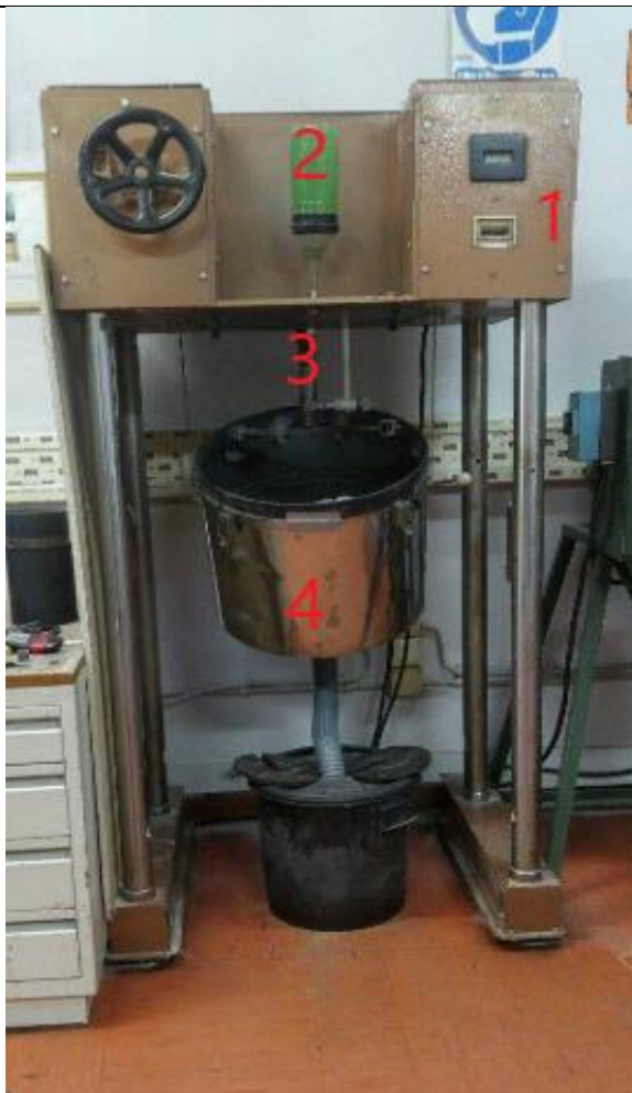
Slika 14. Uređaj za ispitivanje erozije česticama
