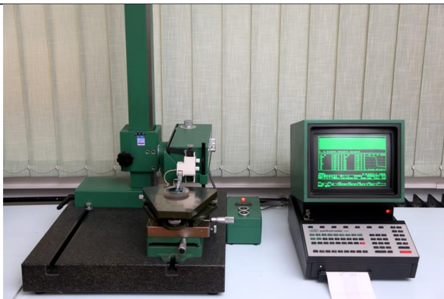
Slika 18. Perthometer S8P, uređaj za mjerenje hrapavosti
