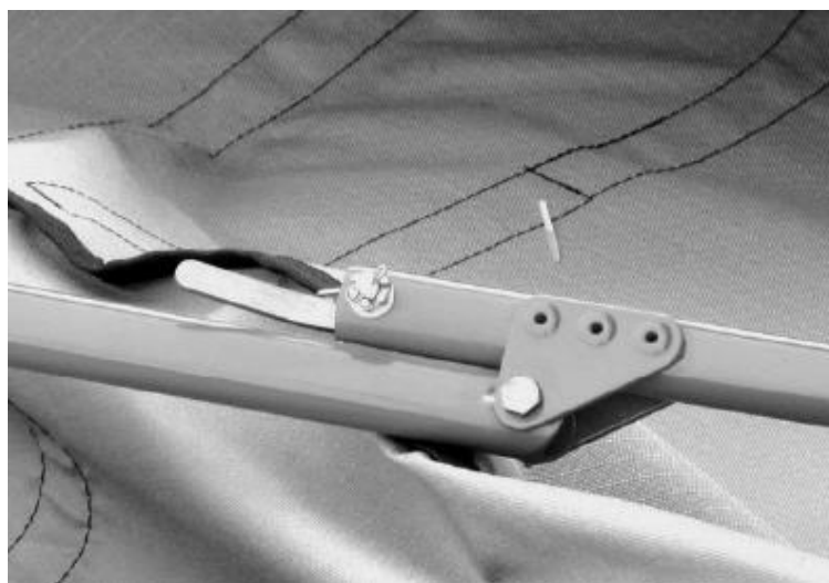
Slika 18. Zglob za sklapanje pomoćnih cijevi stražnjih kotača [9]
