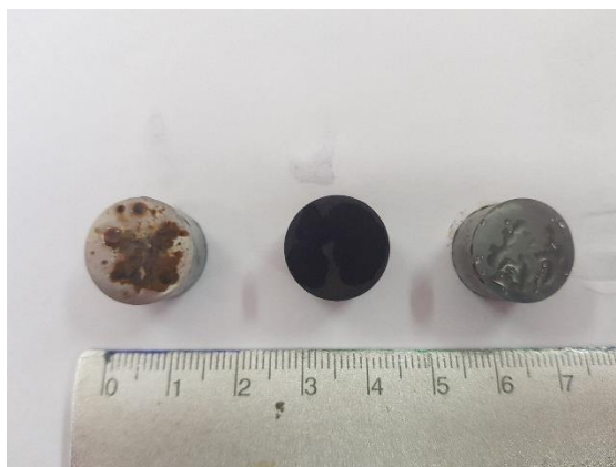
Slika 22. Stanje u vlažnim uvjetima nakon 4h (6-1-7)
