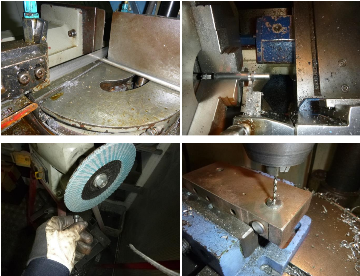
Slika 4. Prikaz postojećeg načina izrade svornjaka
