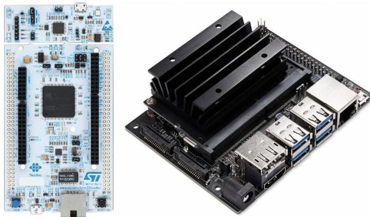
Slika 6. STM32 Nucleo 144 mikrokontroler(lijevo)[7], NVIDIA Jetson Nano mikroprocesor(desno)[8]
