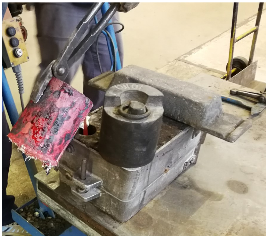
Slika 52. Postupak ulijevanja taljevine
