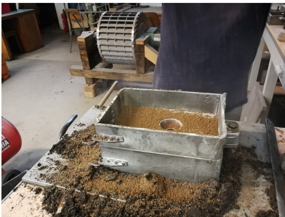
Slika 42. Nasipavanje donjaka modelnom kalupnom mješavinom
