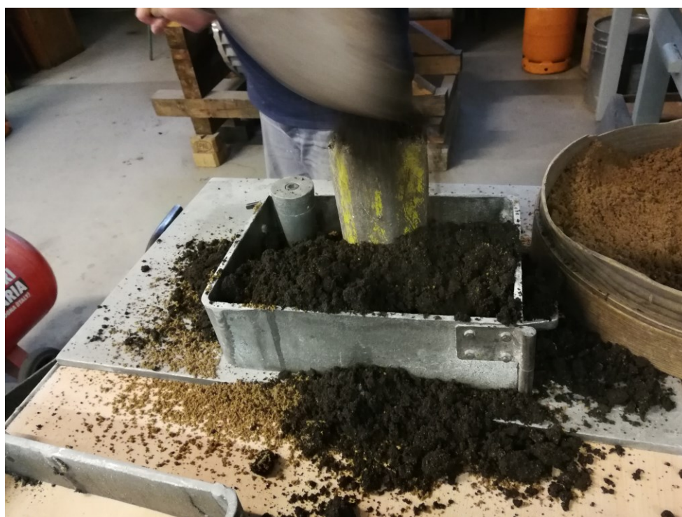
Slika 37. Dodavanje punidbene kalupne mješavine
