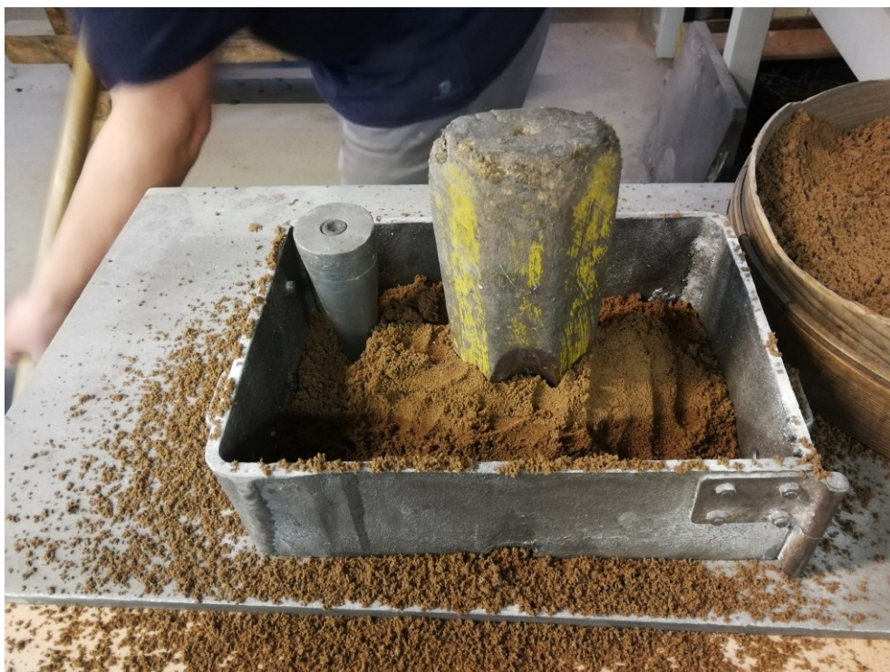
Slika 36. Kalupljenje pojila i spusta u gornjaku
