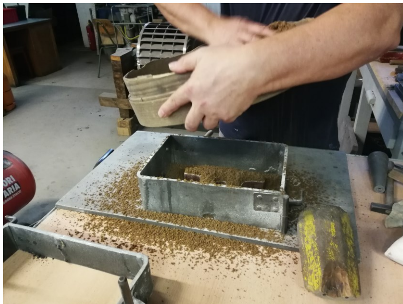
Slika 35. Nasipavanje modelnom kalupnom mješavinom
