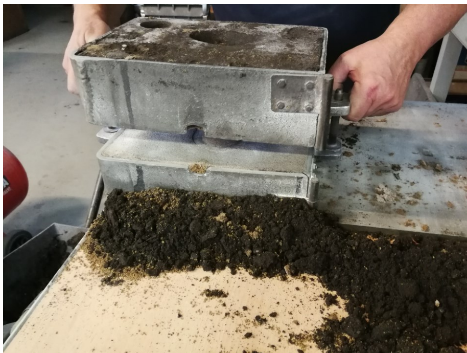
Slika 48. Zatvaranje kalupa prije lijevanja
