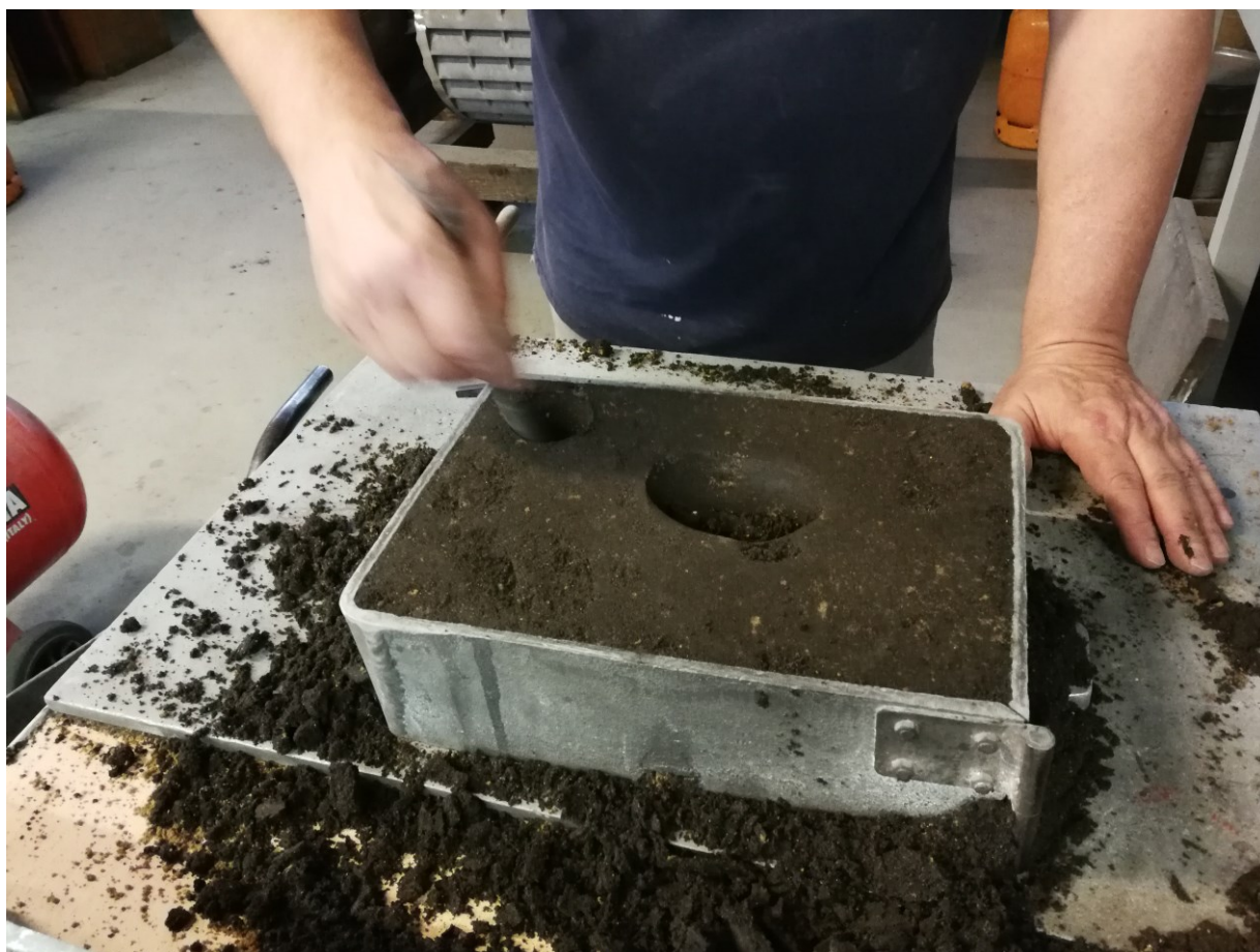
Slika 39. Gornjak nakon vađenja modela pojila i spusta
