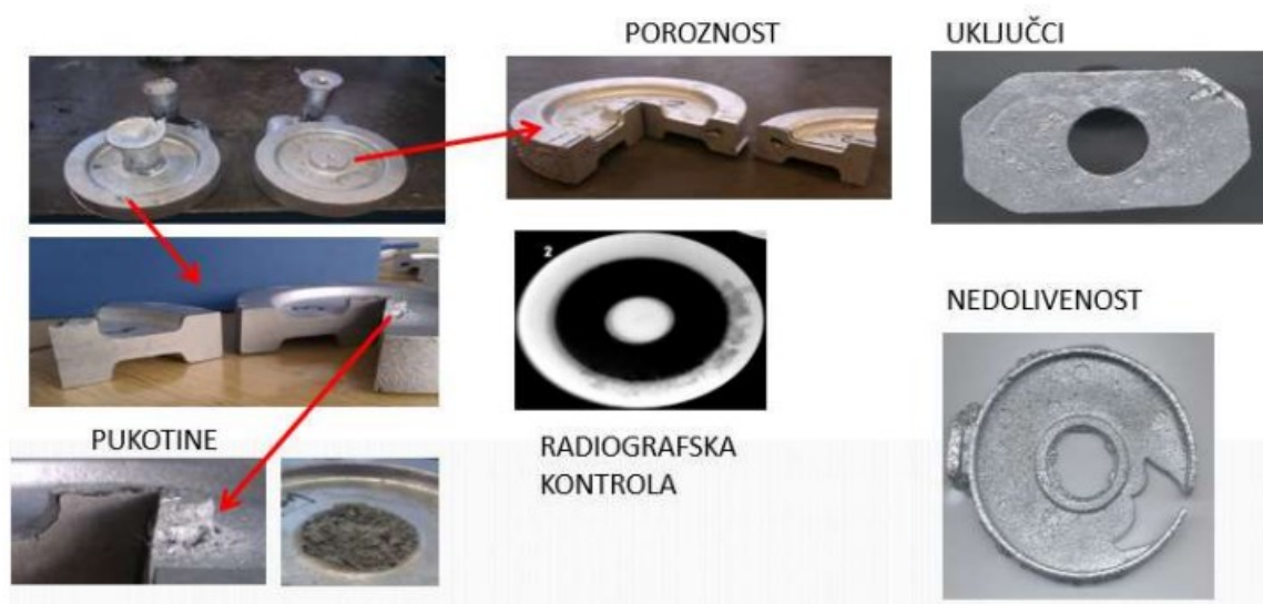
Slika 2. Osnovne greške na odljencima [1]
