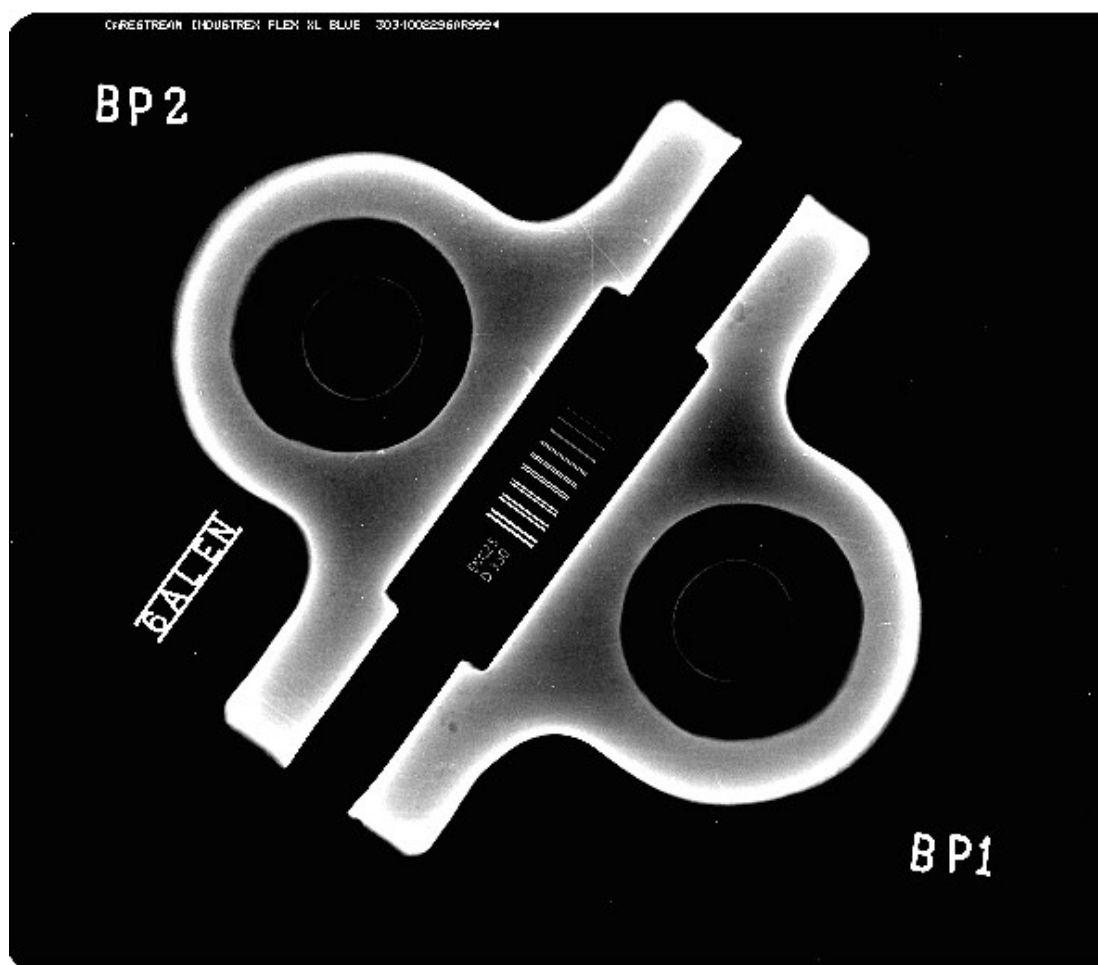
Slika 60. Radiogram odljevaka lijevanih bez pojila
