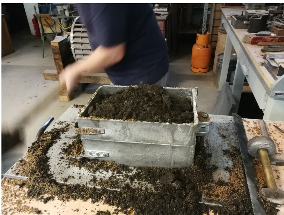
Slika 43. Dodavanje punidbene kalupne mješavine u donjak
