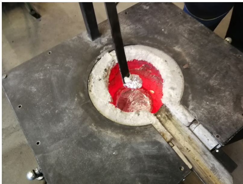
Slika 51. Uklanjanje troske sa površine taljevine
