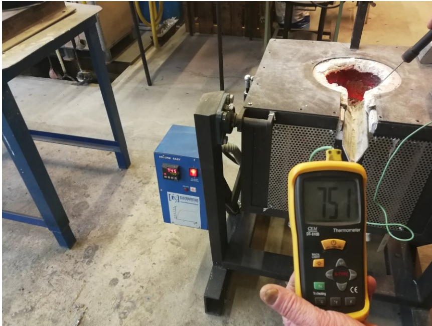
Slika 50. Temperatura taljevine u peći
