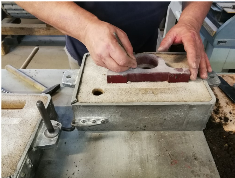
Slika 46. Vađenje drvenih modela iz kalupa
