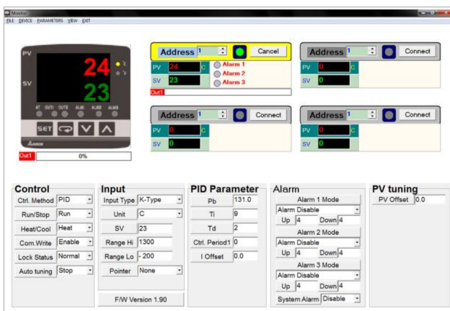
Slika 2.29. Grafičko sučelje programa za upravljanje grijačem zraka
