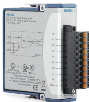
Slika 2.38. Modul NI 9203 za očitavanje jakosti struje [72]
