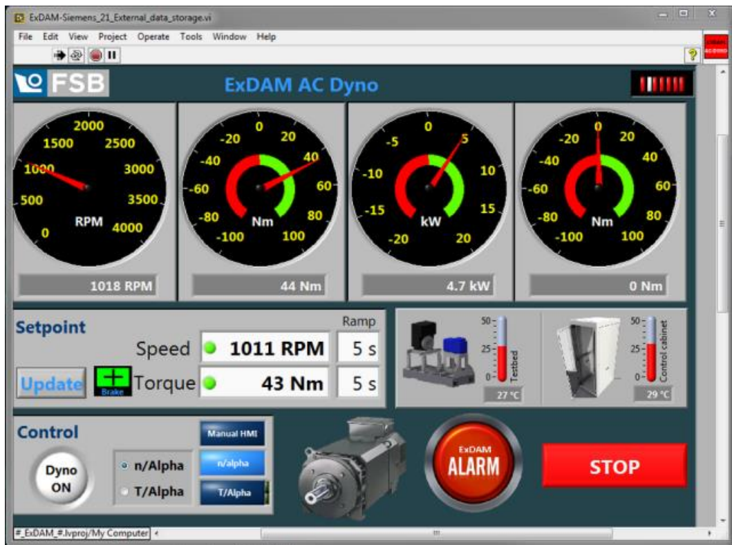
Slika 2.9. Daljinsko upravljačko sučelje kočnice, LabVIEW
