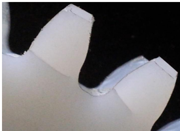
Slika 5.44 Pukotina na polimernom zupčaniku
