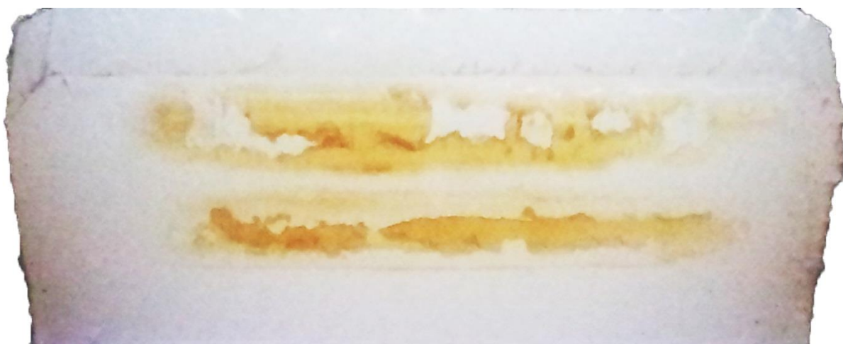
Slika 5.49 Trganje slojeva materijala na boku zuba nakon 40 h rada, T = 20 \text{ Nm} , n = 1000 \text{ min}^{-1}
