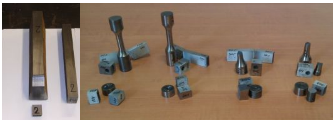
Slika 8. Metalografski uzorci i epruvete iz kojih su izuzeti
