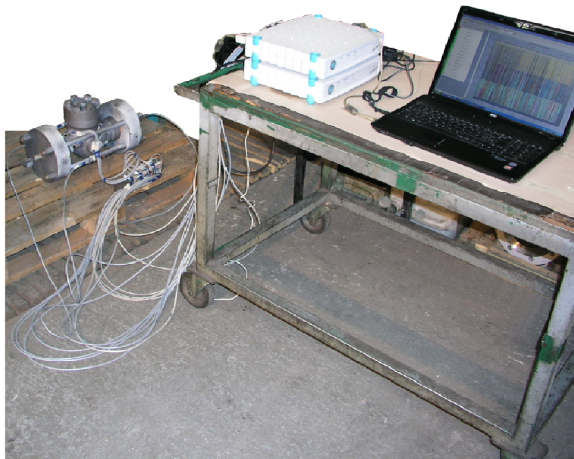
Slika 4.15 Ispitivanje deformiranja kućišta ventila
