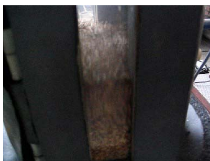
c) velika brzina zraka, intenzivno miješanje zrnja, stapna fluidizacija
