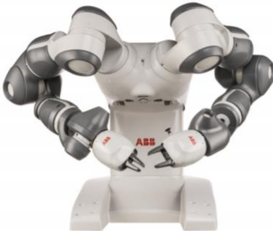
Slika 24. Kolaborativni robot Yumi [29]
