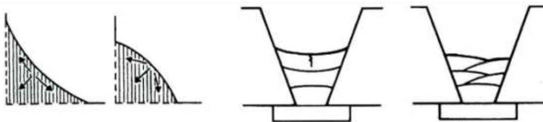
Slika 31. Zavar udubljenog oblika ima veću sklonost pojavi pukotina od zavara blago ispupčenog oblika zbog većih površinskih vlačnih naprezanja [9]
