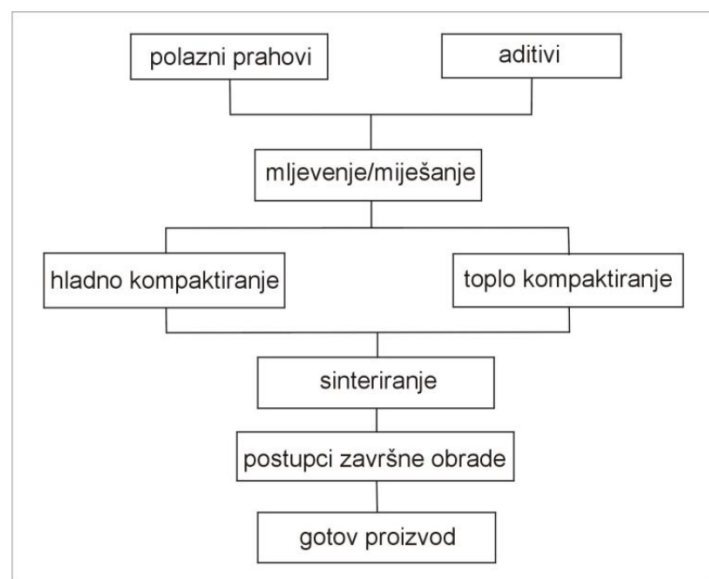
Slika 1: Slijed operacija pri dobivanju proizvoda metalurgijom praha [2]
