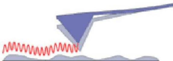
Slika 20. Princip beskontaktnog načina rada AFM-a [24]
