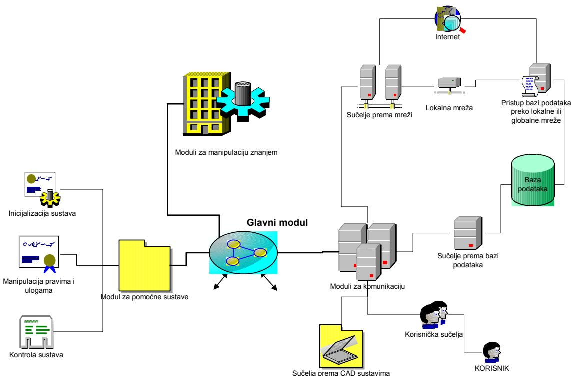
Slika 7-14 Struktura sustava za manipulaciju proširenim CAD modelom
