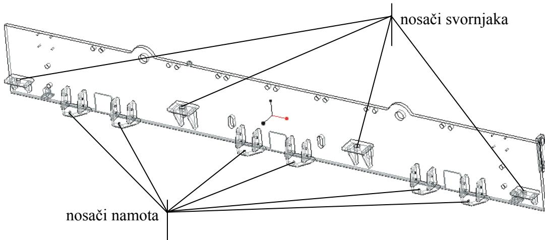
Slika 8-2 Model stezne ploče
