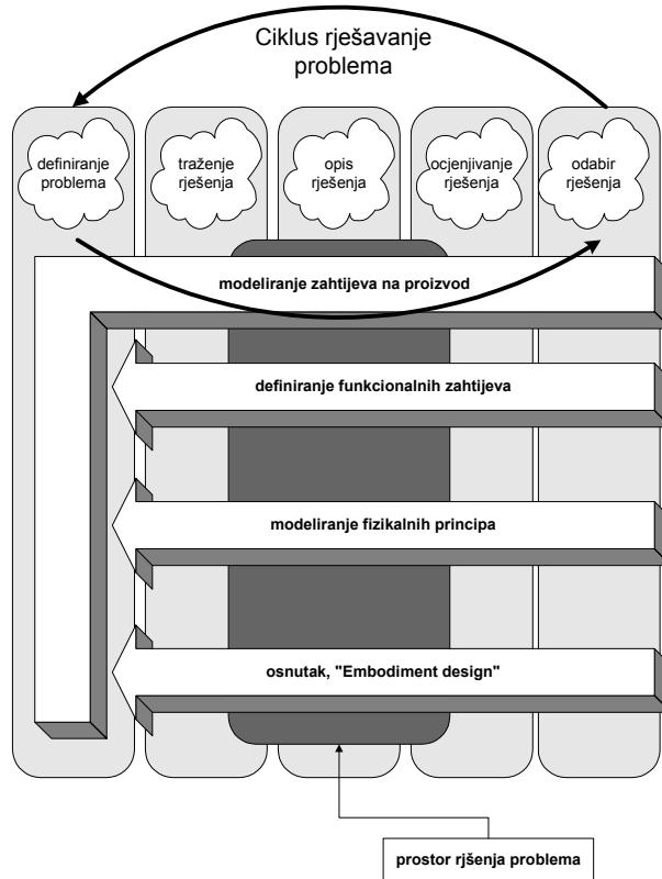
Slika 2-5 Prikaz konstrukcijskog procesa u strojarstvu prema [65]
