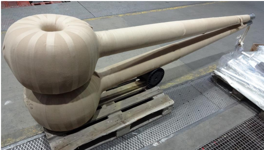
Slika 1.4. Primjer mjernih transformatora spremnih za vakuumsko sušenje
