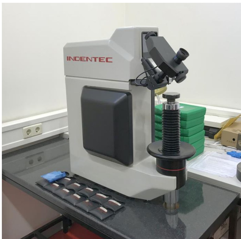
Slika 5.18 Referentni etalon tvrdoće proizvođača Indentec
