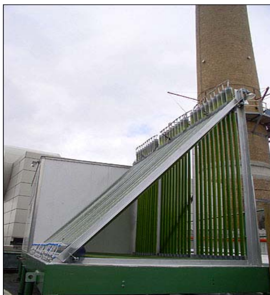
Slika 4.8. Bioreaktor za proizvodnju biodizela od algi
